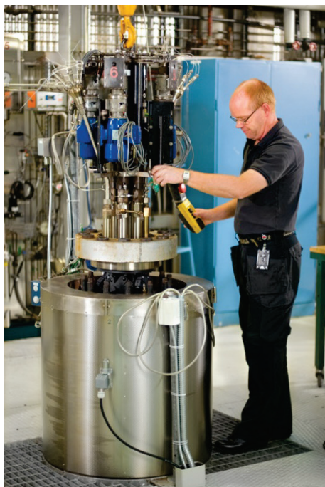
Figur 60 Vänster: Laddning av prover i en autoklav. Höger: Exempel på en uppsättning spricktillväxtprover innan exponering i autoklav.
