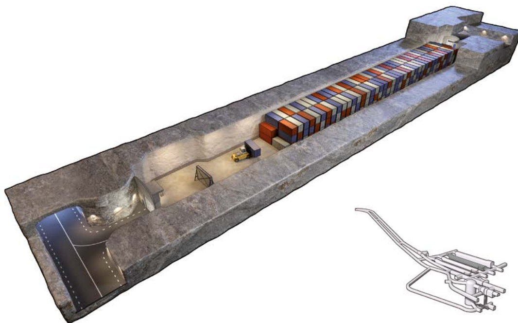
Figur 4-18. Bergssal för lågaktivt avfall, 1BLA, i SFR 1 under driftskedet.
