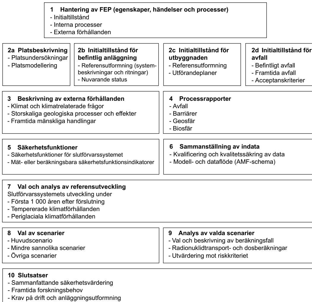
Figur S-3. Översikt över de tio stegen i den metodik som används för säkerhetsanalysen SR-PSU.
