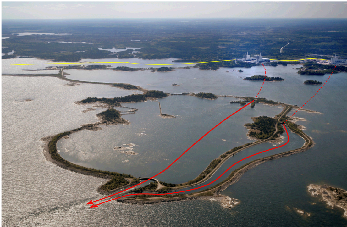
Figur 2-4. Strömningsförhållanden utsläpp av kylvatten från FKA.
