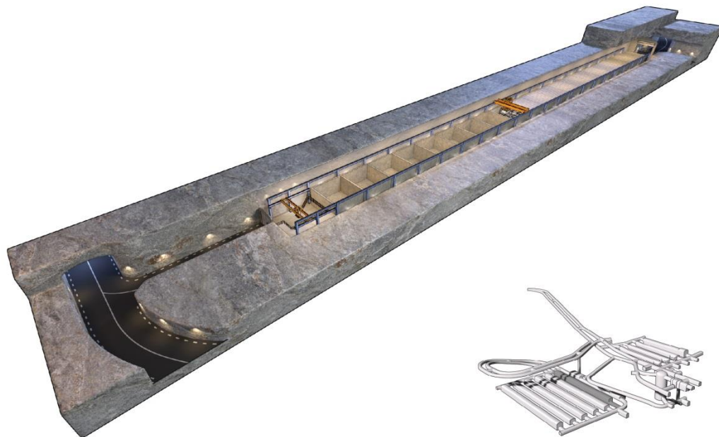
Figur 2-1. Illustration av nya BRT med betongkonstruktion under driftperioden. Bergssalstunneln 2BST och inlastningszonen närmast i figuren.
