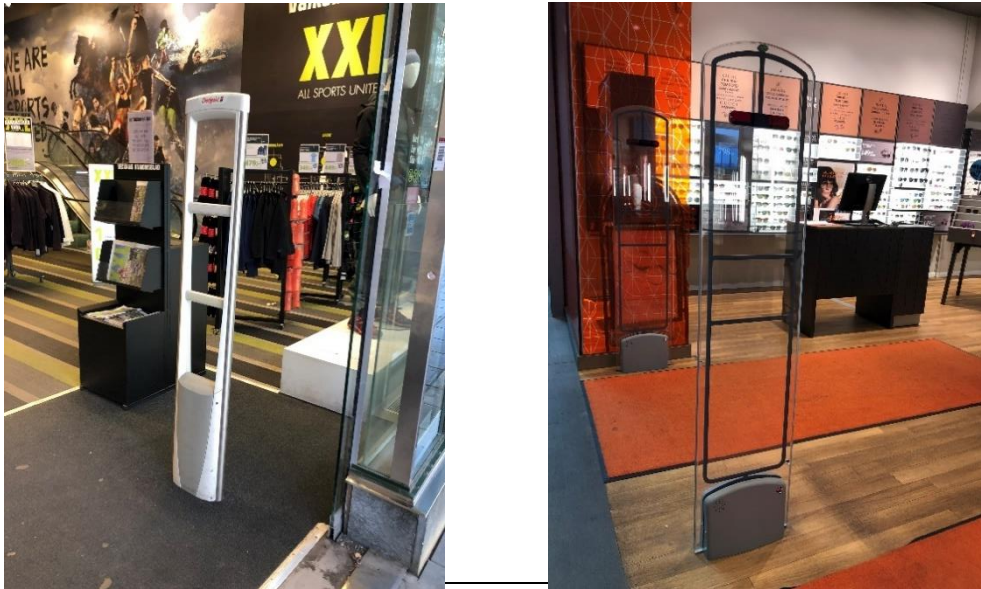
Figur 6. Genombruten larmbåge (vänster) och icke genombruten larmbåge (höger)
