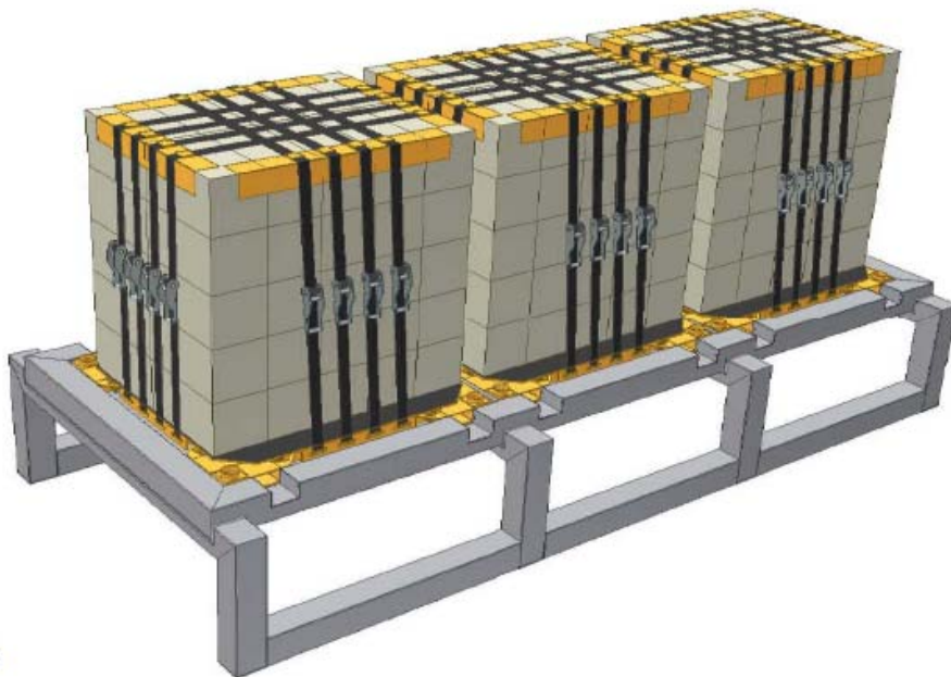
Figur 2-12. Lastbärare med flera lastpallar (preliminär utformning).
