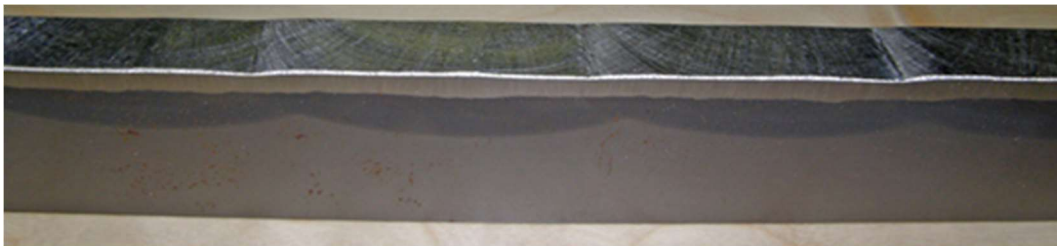
Figur 17 Makroprov för enlager bandpåsvets [3].
